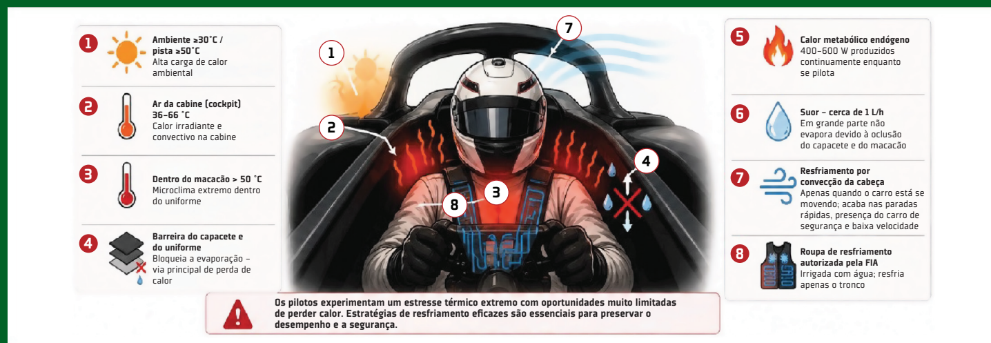
Figura 1: Carga térmica e estresse térmico em um piloto de Fórmula 1. Carga térmica externa [1–3] age no corpo humano no qual o principal caminho de resfriamento está bloqueado pelo uniforme e capacete exigidos pela FIA [4]; Produção contínua de calor metabólico [5] e suor que em grande parte não evapora [6] compõe o desafio. As únicas contramedidas durante a corrida controladas pelo piloto são o resfriamento por convecção da cabeça, disponível apenas quando o carro está em velocidade [7] e a roupa de resfriamento irrigada com água autorizada pela FIA cobrindo apenas o tronco.
